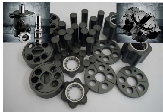
图11 抗磨蚀涂层在海水液压马达领域的应用 [92]
